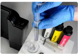
1.4 Pour utiliser la même seringue avec différents pigments ou résines, retirez le piston du tube de la seringue et rincez ces éléments à l'alcool isopropylique propre. Répétez le nettoyage si nécessaire.
