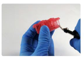
Des ciseaux de précision bien aiguisés peuvent être utilisés pour couper les supports au plus près de la pièce dans un second temps.
